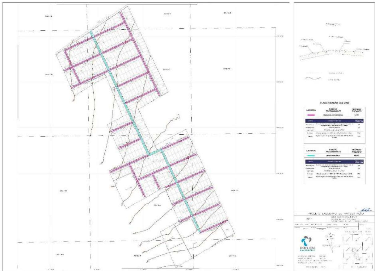
**Figura 5: Planta de Classificação de Vias (tráfego leve na cor magenta) e (tráfego médio na cor ciano).**
