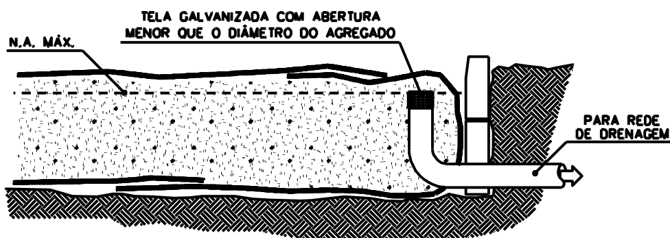
Figura 8.6. Instalação do extravasador
